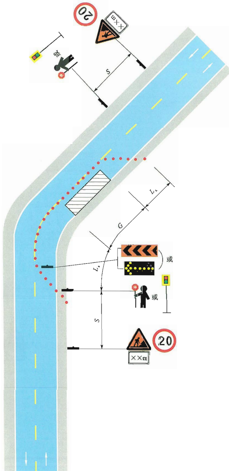
图 7.2.6-3 二、三级公路弯道路段临时养护作业
